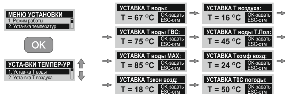
Рисунок 22. Установка температурных параметров
